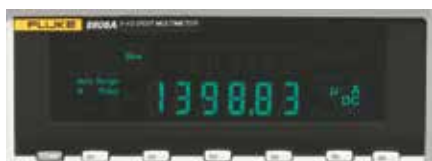
De Fluke 8808A heeft twee lage stroombereiken met lage impedantie voor het meten van lekstromen
