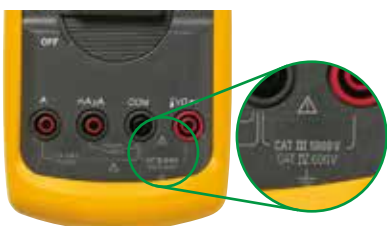
Gebruik meters met de volgende markeringen: 1000 V CAT III of 600 V CAT IV
